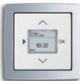
Das Komfort-Timer-Bedienelement bietet noch mehr: 3 Auf- und 3 Abfahrzeiten pro Tag, Rollläden wie auch Jalousien können per Sonnen-, Temperatur- und Glasbruchsensoren über den 6411 U/S-101 gesteuert werden. Man kann Astro- und feste Zeitbefehle mischen, zum Beispiel zum Schalten einer Außenbeleuchtung. In Kombination mit Dimmern steht eine Vielzahl von Möglichkeiten zur Verfügung.
