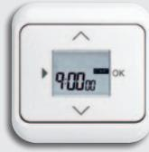
Frei programmierbarer Kurzzeittimer im Bereich von 1 Sekunde bis 9 Stunden, 59 Minuten und 59 Sekunden. Die aktuell eingestellte Zeit bleibt nach Ablauf erhalten und kann immer wieder aufgerufen werden. Der Kurzzeittimer lässt sich jederzeit anhalten (elektronische „Eieruhr“). In den Einstellungen des Gerätes lassen sich bei Bedarf die programmierten Zeiten vor unbefugtem Zugriff schützen.
