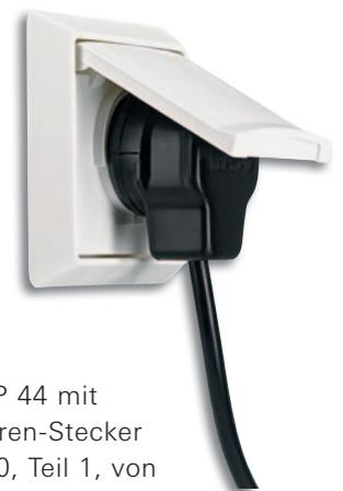
Erfüllung der Norm IP 44 mit eingestecktem Konturen-Stecker gemäß DIN VDE 0620, Teil 1, von 2013. Mit anderen Steckern ist die Schutzart **nicht** gegeben.
